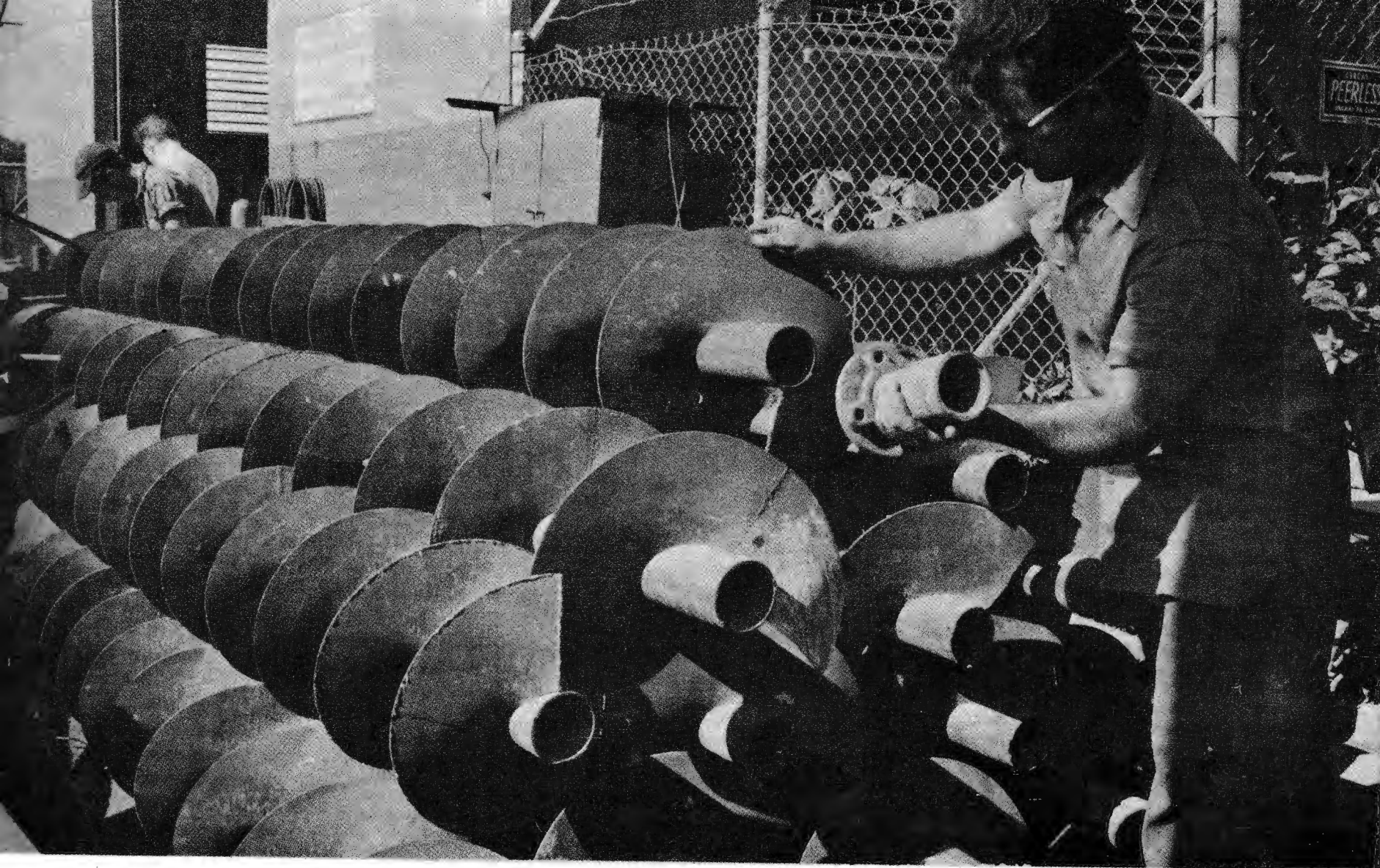
El mecánico-soldador Emilio Hernández, junto a los sinfines construidos en los talleres de la Empresa Consolidada.
